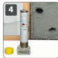
4 Dichteproofung am befüllten Prüfelement mit Dichtprüfset NW100
