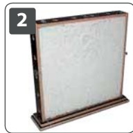
2 Öffnen des Prüfelements und begutachten des Befüllergebnisses
